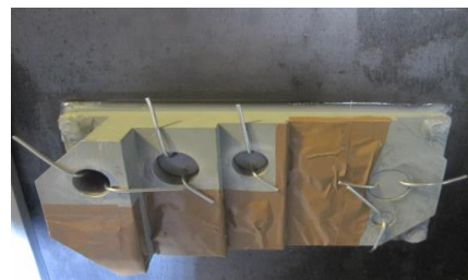
気密試験対象プラグ (目張りテープのプラグは水密試験用)
