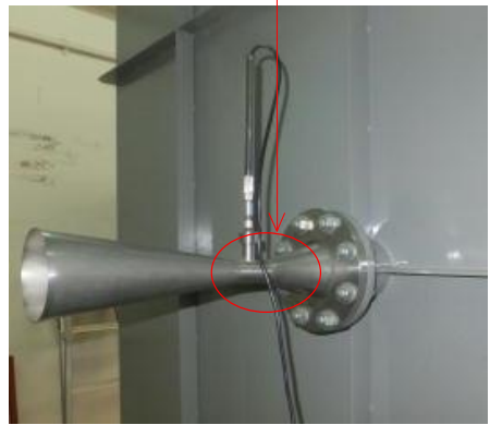
気密試験をするとき人用とする捕集箱
