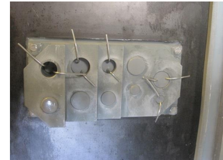
圧力箱室内から見たときの供試体配置状況
