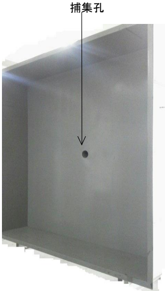
C-Cから見たときの気密試験用捕集箱
