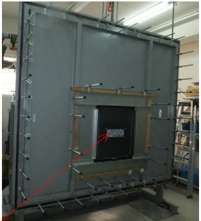
B-Bから見たときの供試体位置 シリコンプラグ供試体
