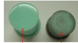
汚れ防止加工なし 汚れ防止加工済み
