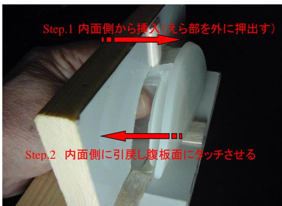
Step.1 内面側から挿入(えら部を外に押出す)
