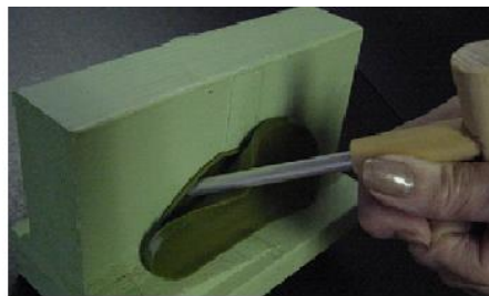
押し込み治具でえらを母材厚内へ押し込みます。
